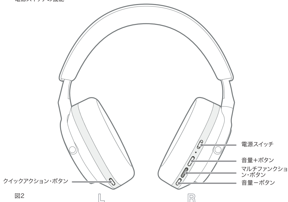
図1 電源スイッチの機能
